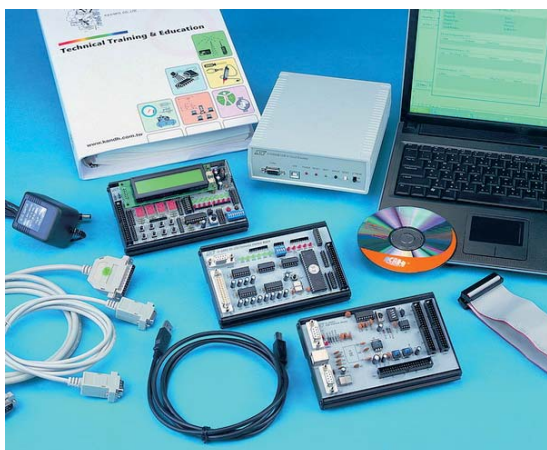
Interfaces de USB 2.0, RS-232C y Centronics.
