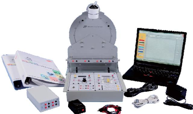
El entrenador de la célula solar GES-100 es un entrenador fácil y autónomo diseñado para el aprendizaje de la configuración básica y características de la célula solar.
