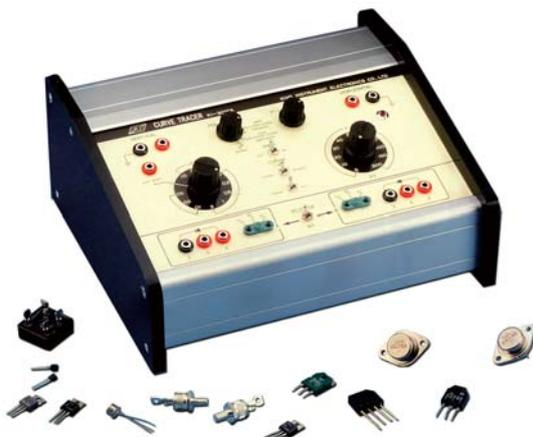
El trazado de curvas sobre un ámbito de aplicación puede realizarse fácilmente con el KI-3020A. Sin embargo, sólo se requiere un Osciloscopio Sync. Curvas características de todos los tipos de semiconductores-transistor se muestran con precisión, tales como el FET, diodos, diodo Zener, SCR, TRIAC, DIAC, UJT, etc.
