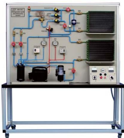
KR-115 es diseñado para aprender la teoría de Transferencia de Calor en la ingeniería de refrigeración. Con la configuración adecuada, KR-115 puede ser emulado como sistema de refrigeración o bomba de calor. Todos los componentes del sistema, están montados en el panel frontal, para que los estudiantes pueden observar, tocar y oír el ruido que produce el componente cuando está funcionando ya sea durante el ciclo de refrigeración o bomba de calor.
